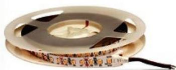
Tira LED de luz neutra con doble pista de cobre para mejor transmisión de corriente y disipación del calor. Fraccionable cada 5 cm con pegamento en el dorso para facilitar su instalación. Es dimeable y su vida útil es de 50.000 hs.
